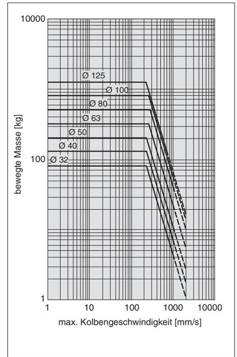
Beispiel: Ermitteln Sie die max. bewegte Masse am Kolbenstangenende eines Ø 63-Druckluftzylinders bei einer Kolbengeschwindigkeit von 500 mm/s. Suchen Sie den Schnittpunkt der vertikalen Achse für 500 mm/s und der Linie für Ø 63 mm und entnehmen Sie den entsprechenden Wert für die max. bewegte Masse am linken Rand. In diesem Fall beträgt die max. bewegte Last 80 kg.
