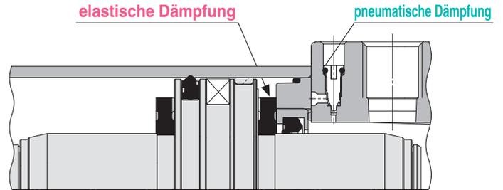
Die Kolbenstangenmutter kann bis zum theoretischen Bezugspunkt eingeschraubt werden.
