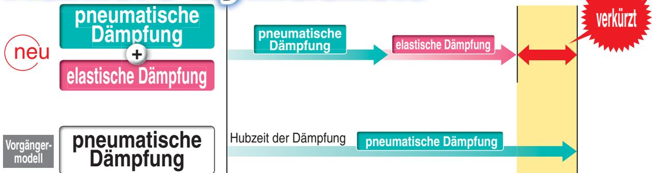
■ Elastische Dämpfung reduziert Stoßgeräusch beim Erreichen der Endlage
