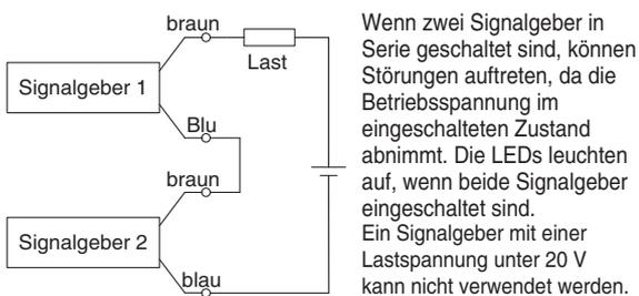
$$\begin{aligned} \text{Betriebsspannung bei ON} &= \text{Versorgungsspannung} - \\ &= \text{Restspannung} \times 2 \text{ Stk.} \\ &= 24 \text{ V} - 4 \text{ V} \times 2 \text{ Stk.} \\ &= 16 \text{ V} \end{aligned}$$
